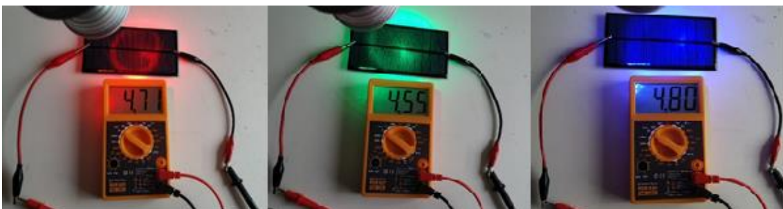
Figura A - 27 – Tensão gerada por iluminação com lâmpada led
