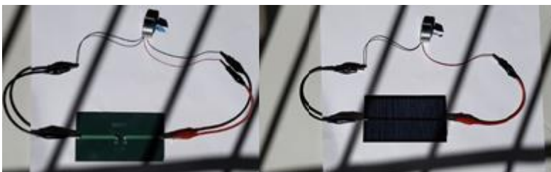
Figura A - 17 - Conexão da placa aos terminais do motor
