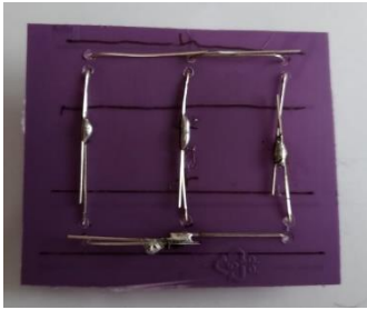
Figura A - 39 - Solda dos terminais negativos
