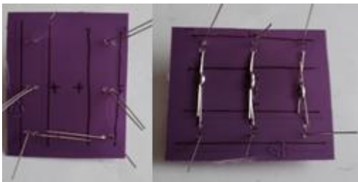
Figura A - 38 - Solda dos terminais positivos
