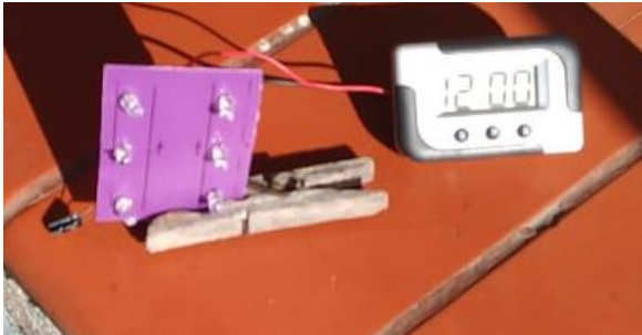
Figura A - 42 - Funcionamento de um pequeno relógio
