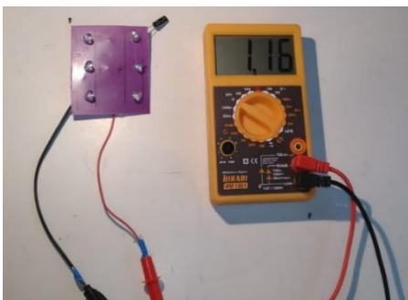
Figura A - 41 - Medida da tensão da placa
