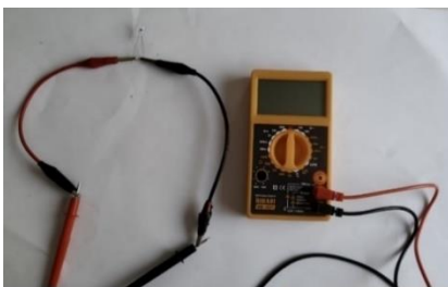
Figura A - 33 - Conectando o led ao multímetro
