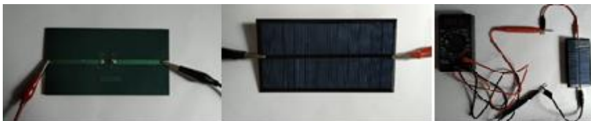
Figura A - 15 - Conexão da placa ao multímetro
