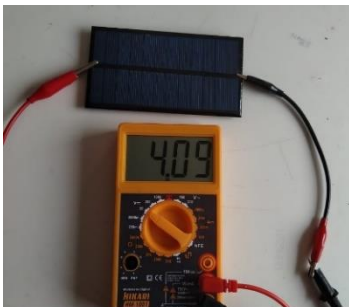
Figura A - 26 – Tensão gerada pela iluminação ambiente
